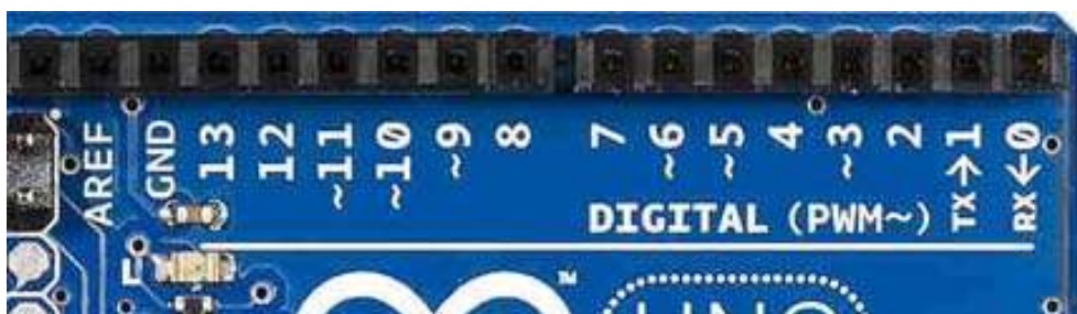
Рисунок 1.7 – Контакты Arduino UNO
