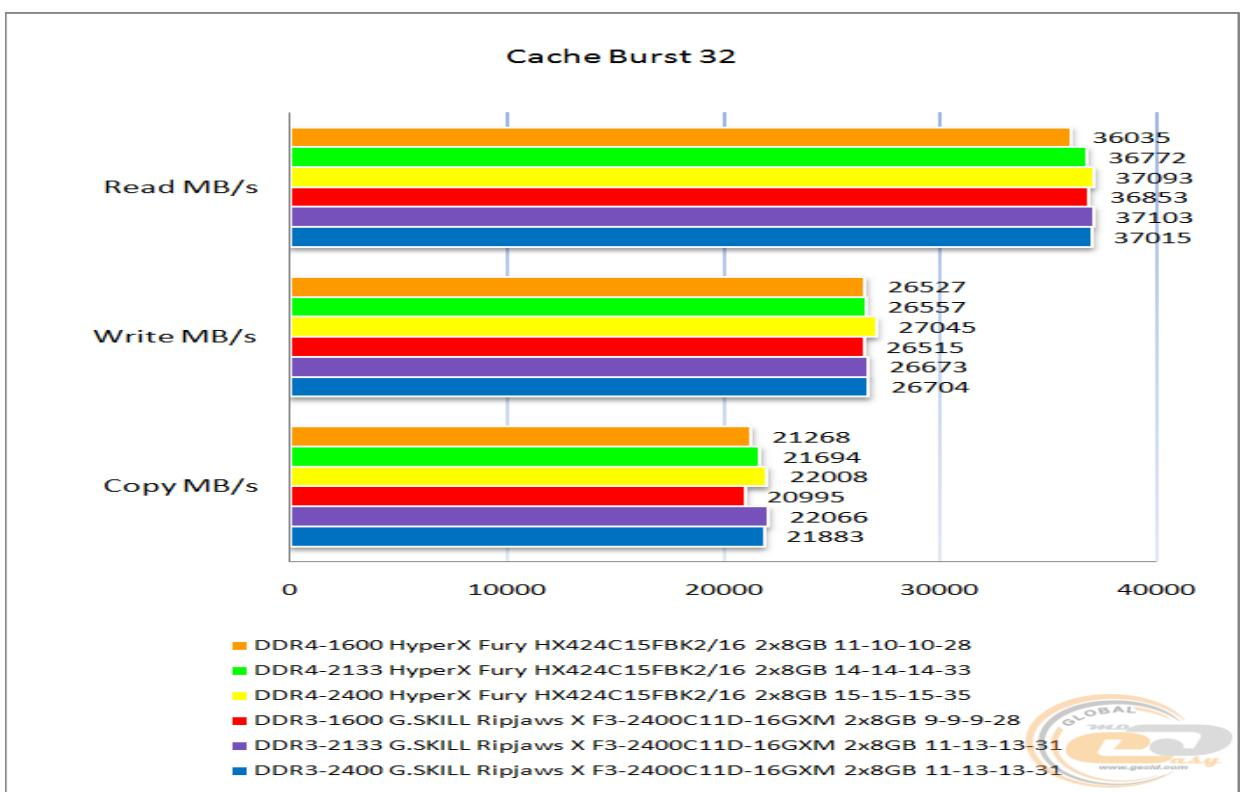
В бенчмарках, напрямую зависящих от частоты модулей памяти, оба комплекта продемонстрировали сопоставимые результаты, причем во всех режимах. В большинстве случаев разница составляла не больше 0,5%, так что здесь между DDR4 и DDR3 наблюдается паритет.
