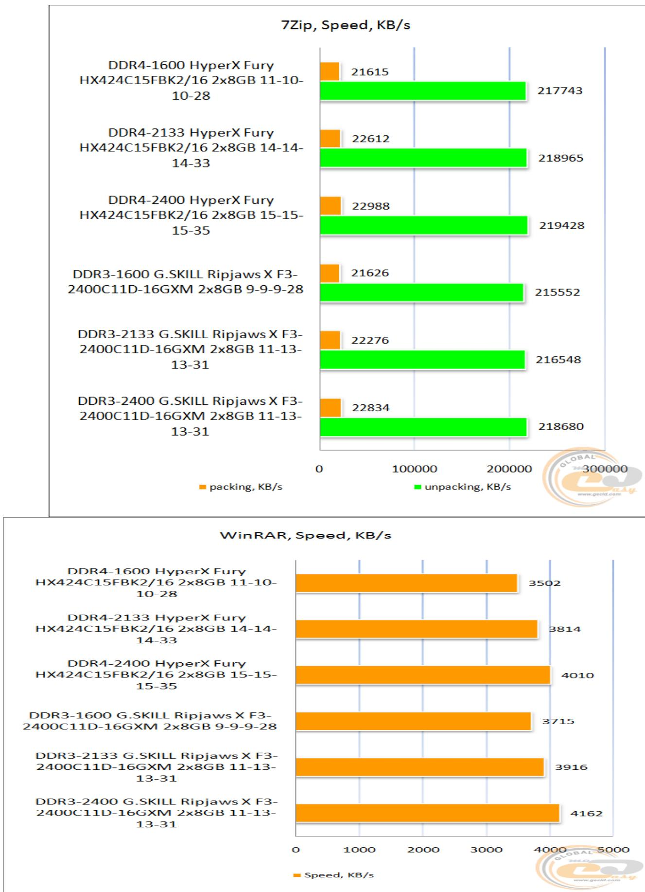
В тестах, где измеряется задержка при чтении процессором данных из памяти и скорость работы ПК в задачах, связанных с архивированием, перевес был на стороне модулей стандарта DDR3. В среднем разница составляла 4-5%. Такой разрыв объясняется тем, что для функционирования на одинаковой частоте памяти DDR3 требуются более низкие тайминги, чем DDR4.
