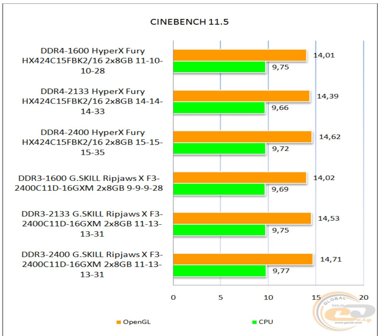
Приложения, которые используются для моделирования объектов и выполнения сложных расчетов, лучше реагируют на повышение частоты памяти, чем на изменение набора задержек. Поэтому в данном случае работа на более низких таймингах для памяти DDR3 не принесла практически никаких дивидендов. По крайней мере, перевес на уровне 0,6 – 0,9% мы не склонны считать тем преимуществом, на которое стоит обращать серьезное внимание.
