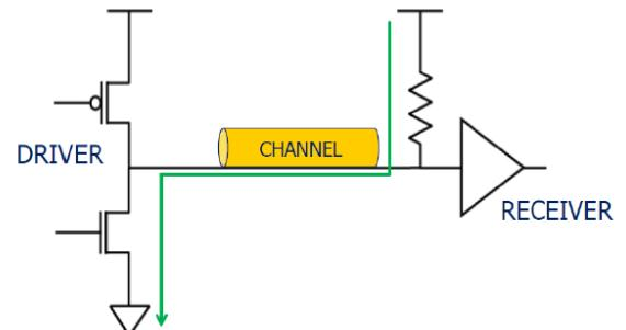
Память DDR4 также получила усовершенствованный интерфейс ввода/вывода данных под названием «Pseudo-Open Drain» (POD). От используемого ранее Series-Stub Terminated Logic (SSTL) он отличается отсутствием утечки тока на уровне драйверов ячеек памяти.
