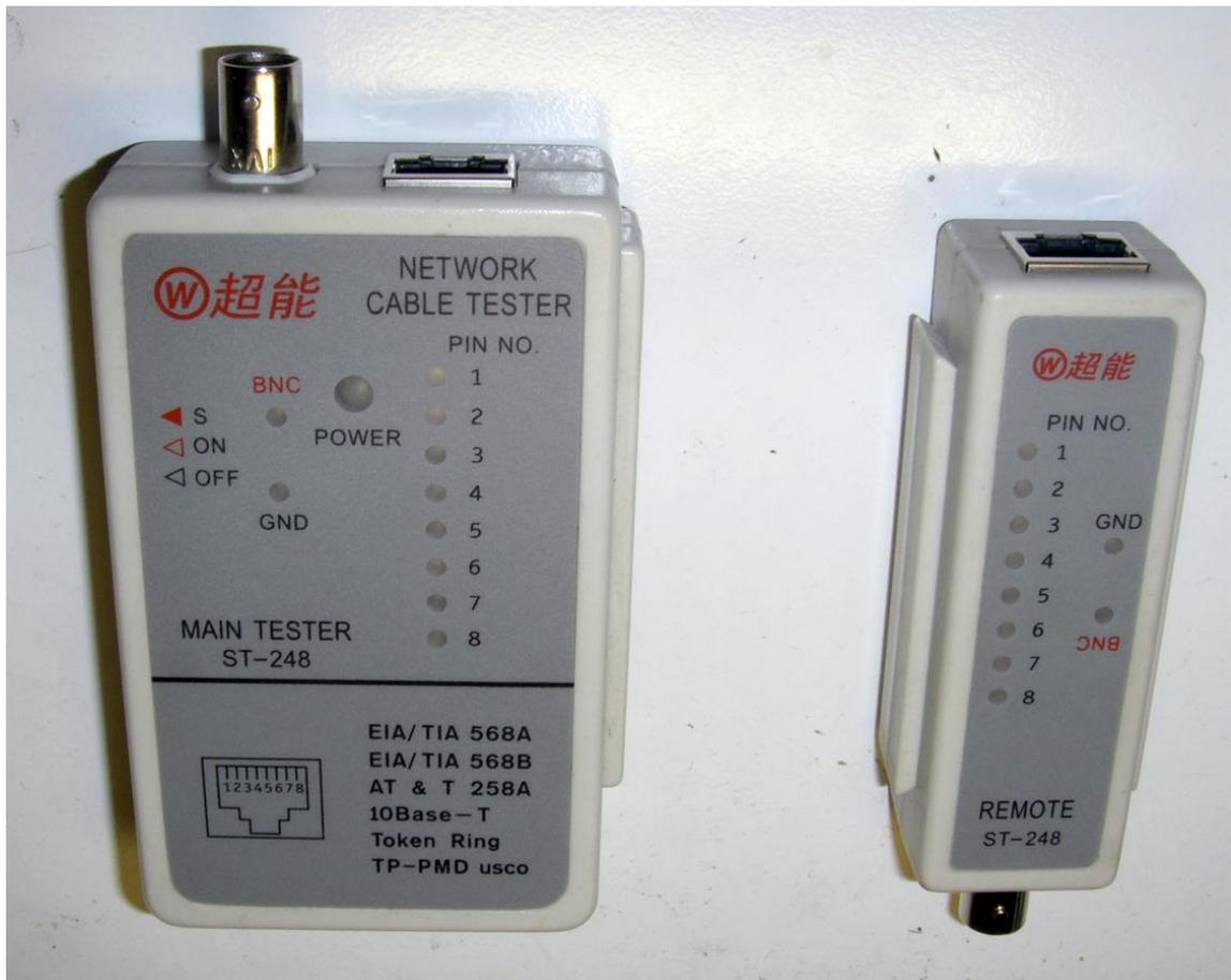
**Рис.1.1 – Готовый вариант тестера**
