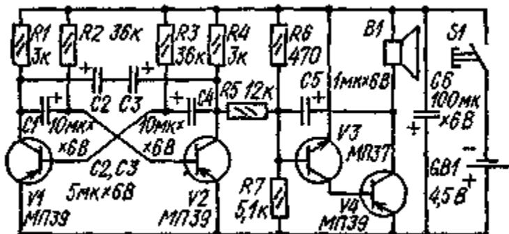
На рисунке показана схема двухтонального звонка на мультивибраторе. Двухтональный звонок состоит из двух генераторов: генератора тона (транзисторы V3 и V4) и симметричного мультивибратора (транзисторы V1 и V2).
