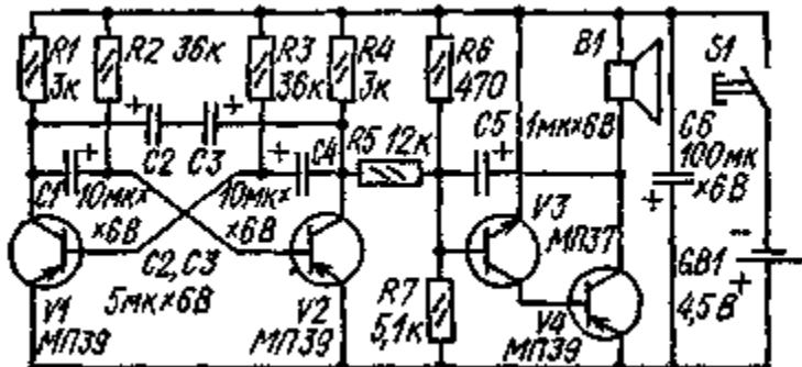
На рисунке показана схема двухтонального звонка на мультивибратора. Двухтональный звонок состоит из двух генераторов: генератора тона (транзисторы V3 и V4) и симметричного мультивибратора (транзисторы V1 и V2).
