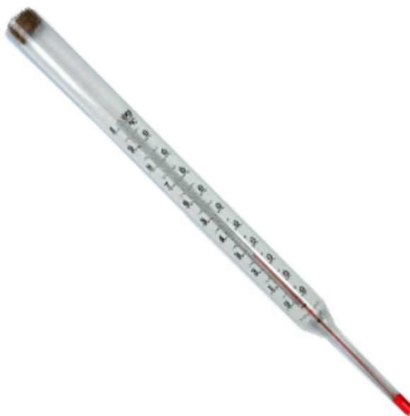
Рисунок 1.2 – Жидкостный термометр
