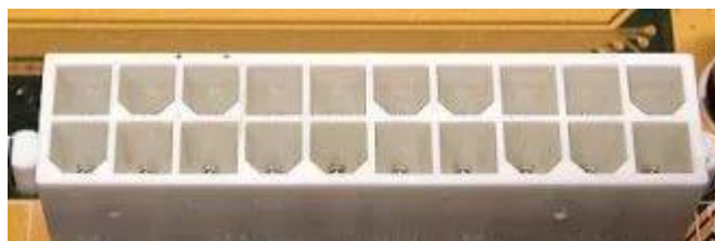
Рисунок 1.6 – 20-контактная вилка ATX для материнской платы
