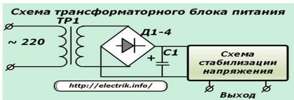
Рисунок 1.1 – Схема трансформатора блока питания
