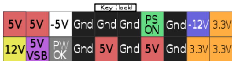
Рисунок 1.4 – цвета проводов на вилке АТХ
