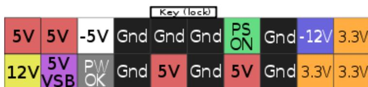
20-контактный разъём ATX (вид на материнскую плату)
