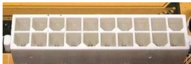
Рисунок 2.6 – 20-контактная вилка ATX для материнской платы
