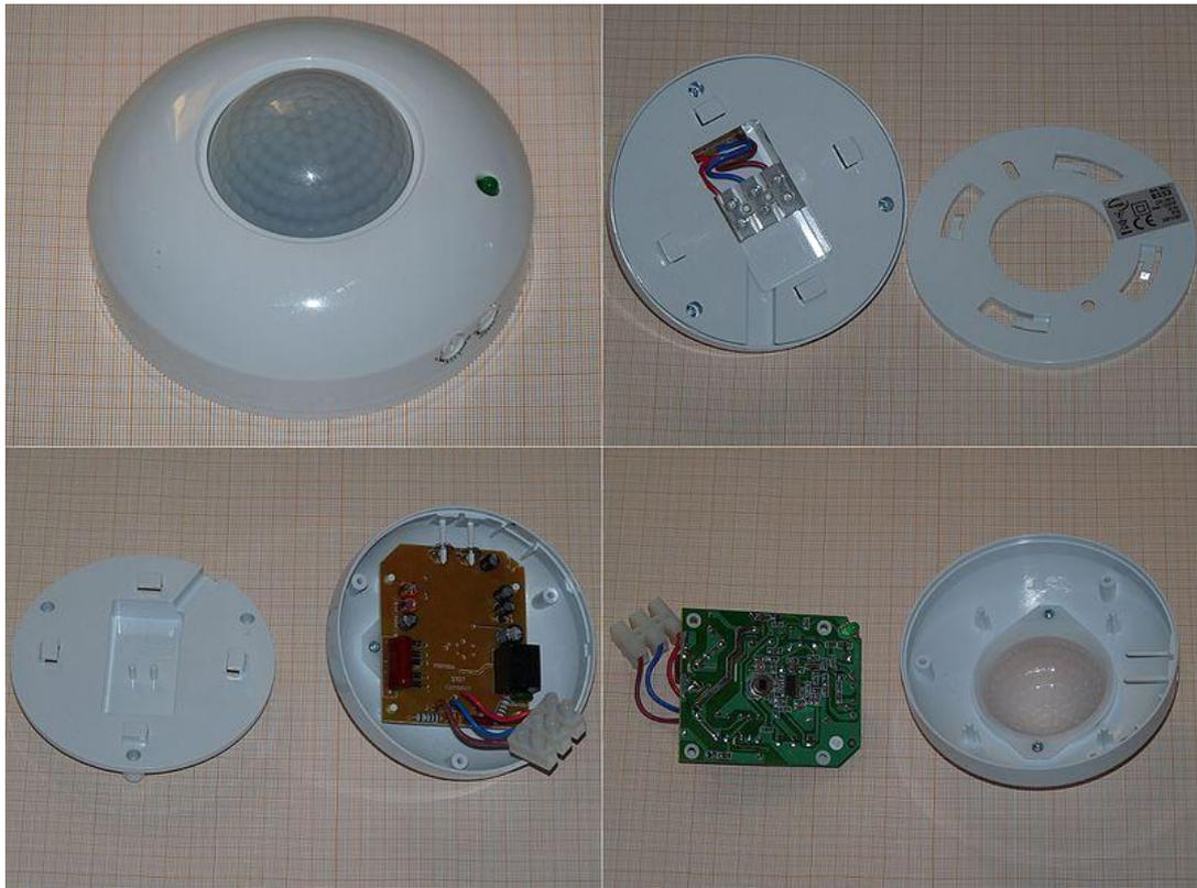
Рисунок 1.4– Инфракрасный датчик движения
