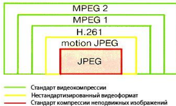
Рис. 3.8. Группа форматов цифрового видео, использующих алгоритм сжатия с потерями, в основе которого лежит метод JPEG . Данная модель даёт хорошее представление о повышении сложности, увеличении степени сжатия и улучшении чёткости изображения при переходе от формата JPEG к H.261 и далее к MPEG . Стандарт MPEG1 является подмножеством стандарта MPEG2
