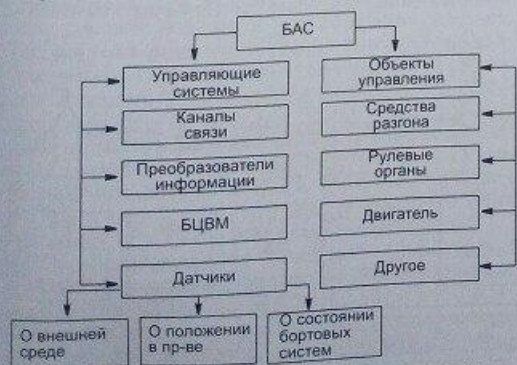
Рис. 1. Общий состав бортовых автоматических систем ЛА
